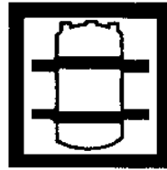
Water Heater (calentador de agua)
